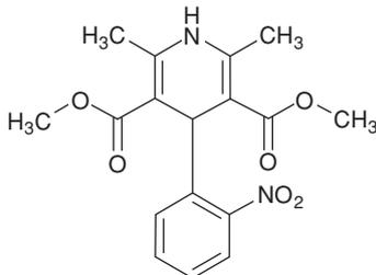
性状：ニフェジピンは黄色の結晶性の粉末で、におい及び味はない。アセトン又はジクロロメタンに溶けやすく、メタノール、エタノール(95)又は酢酸(100)にやや溶けにくく、ジエチルエーテルに溶けにくく、水にほとんど溶けない。光によって変化する。
